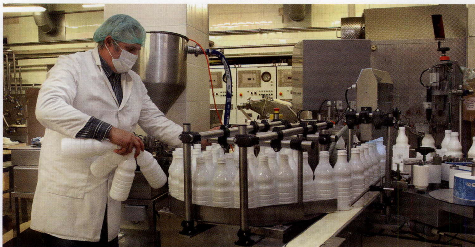
Latvijas uzņēmuma Kamri uzstādītā šķidro piena produktu iepakojšanas iekārta ir par 25 % ražīgāka nekā tās priekštece.
